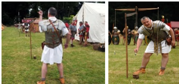
Fig 4 Reconstitution d'une groma et un exemple de son utilisation
